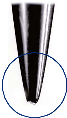
Darstellung einer beschädigten Nadelspitze
