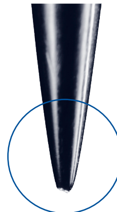
Darstellung einer beschädigten Nadelspitze
