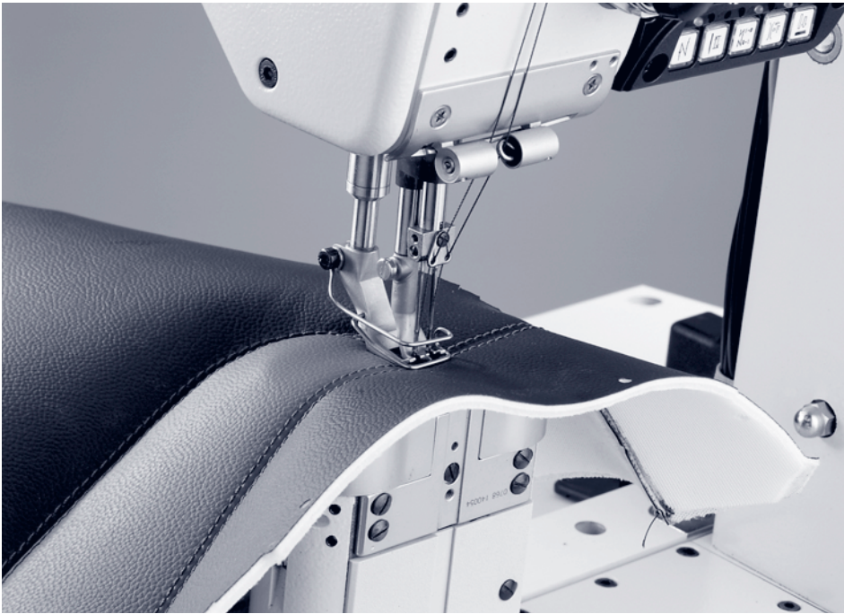
Absteppen von Schließnähten mit einer 2-Nadel-Säulennähmaschine (768-FA-273-RAP-HP)
